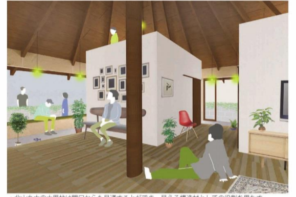
・北山丸太の大黒柱は開口からも見渡すことができ、見える構造材としての役割を果たす。
