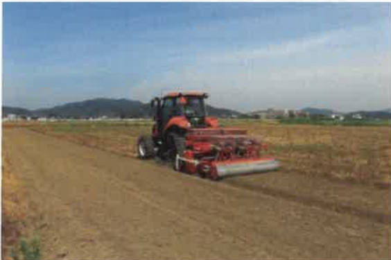
トリプルエコロジーによる耕うん・施肥・は種同時作業
