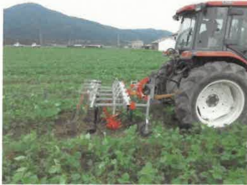
除草カルチによる作業
