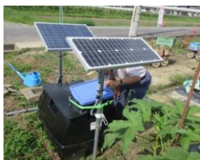
日射制御型拍動自動かん水装置
