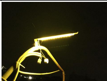
黄色LED点灯により害虫忌避
