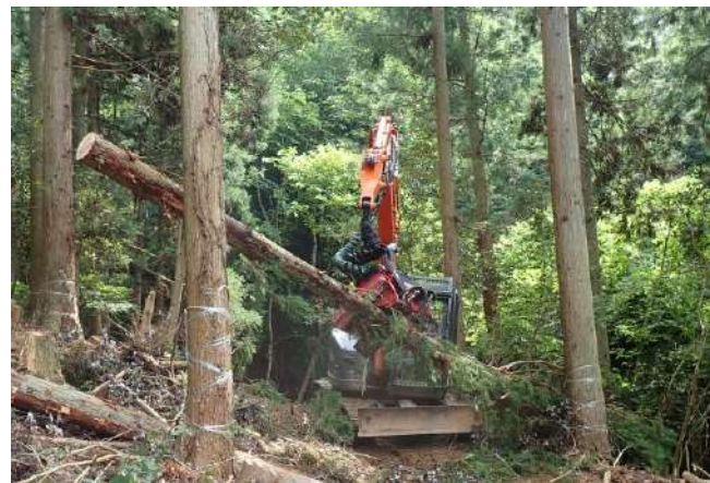
高性能林業機械を用いた施業の様子 (ハーベスタによる造材)
