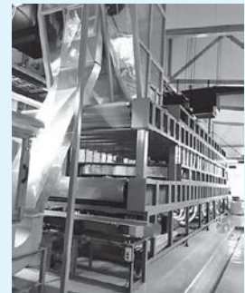
オープンラボ（食品加工研究室、機器分析研究室）（左） 遠赤外線ヒーターを熱源とする新型のてん茶乾燥機（右）
