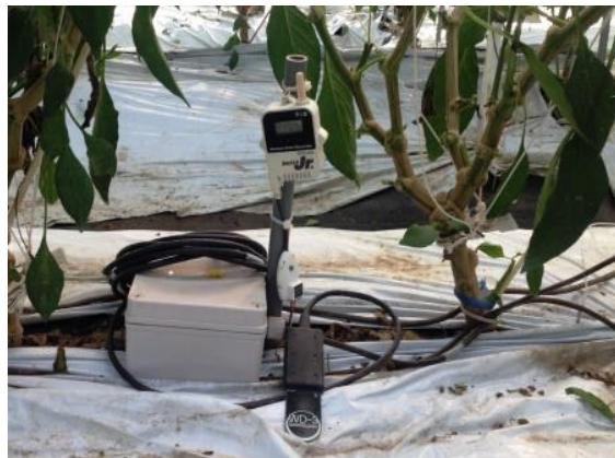
設置した土壤水分センサー (センサー部分は地下15cmに埋設)
