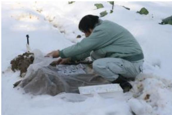
各種肥料の窒素溶出量を調べる埋設試験
