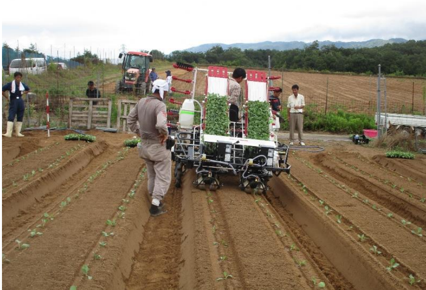
傾斜地での定植機利用によるキャベツ定植の実演
