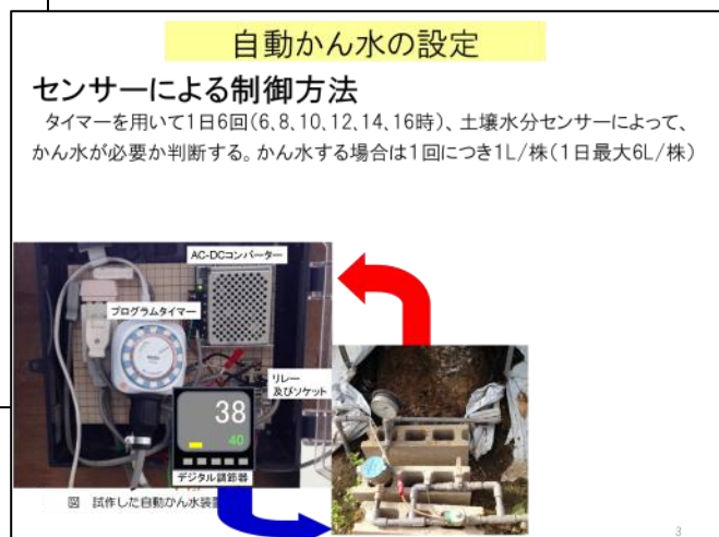
自動かん水装置による制御方法（学会報告から抜粋）
