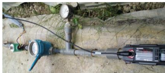
かん水量を自動で計測する装置（写真右側）
