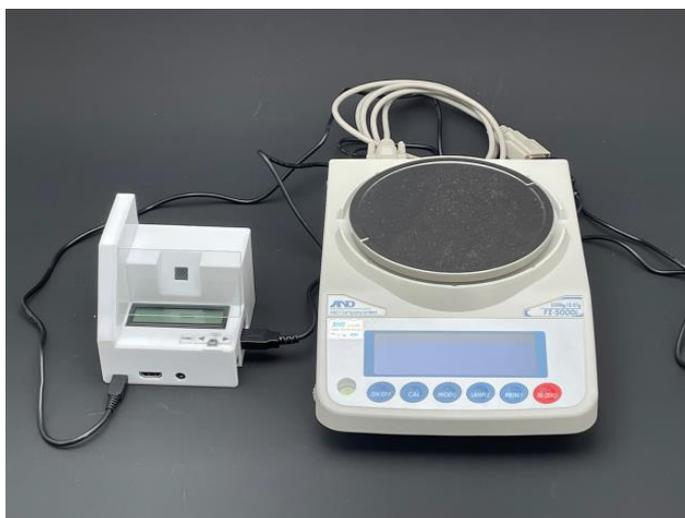
薬品管理システムの外観：センサー端末部(左)と電子天秤(右)
