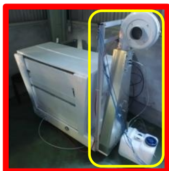
図1 細霧を利用して冷却・加湿する開発装置
