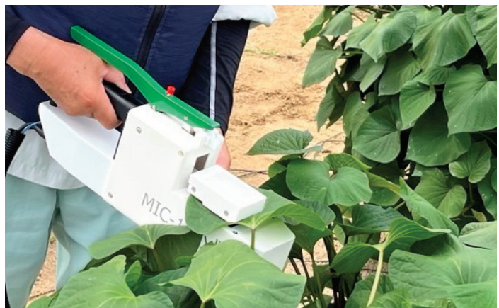
光合成速度測定装置とその使用状況 (葉を装置で挟み、光合成がどれだけ効率的 に行われているか測定)
