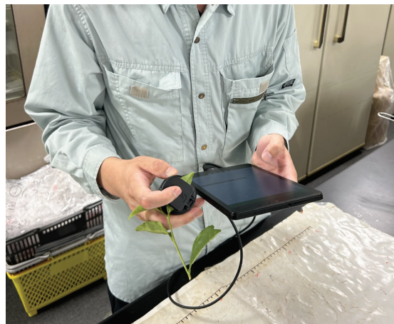
機器が有線でつながるため 生葉の測定がしづらい様子
