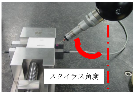
図 3 ブロックゲージの測定とスタイラス角度
