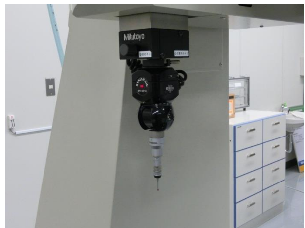
図2 プロービングシステム外観 ミットヨ CNC 三次元座標測定機(図1) BRT-A707
