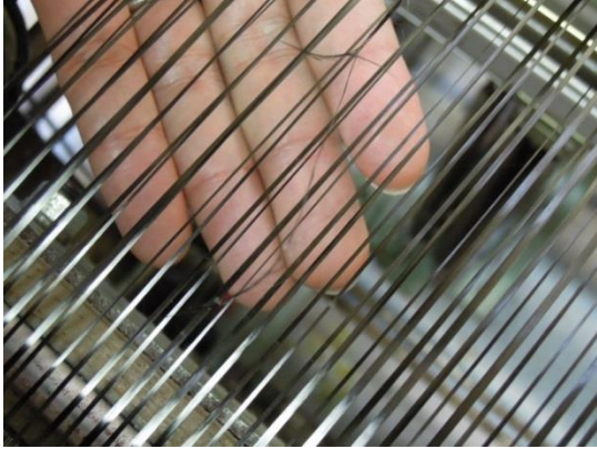
写真1 箴羽との擦れによるたて糸の折損
