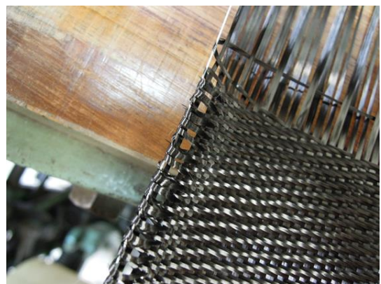
写真3 よこ糸の折損(織物左端)
