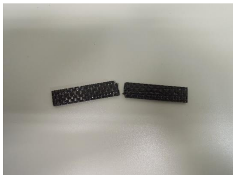
図 8 衝撃試験後の試料 (試料 A)
