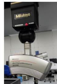
図 1 ラインレーザプローブ外観((株)ミツヨ製)
