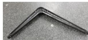
図 6 CFRP 成形品の外観
