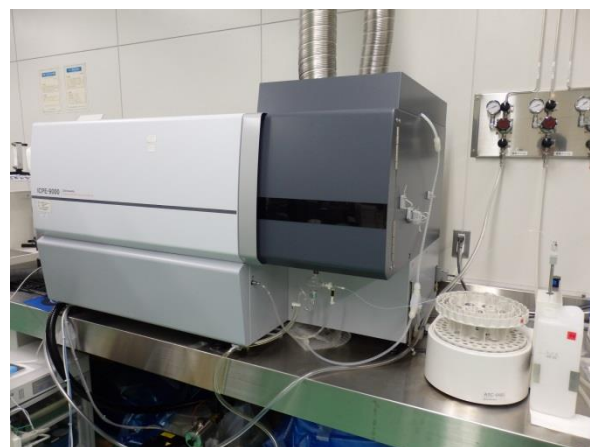
図2 ICP 発光分析装置(島津製作所 ICPE-9000)
