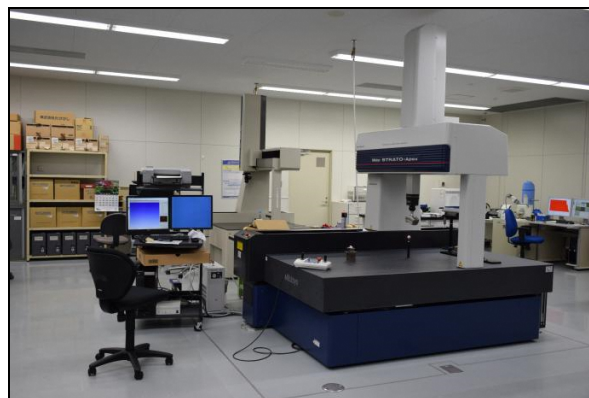
図1 装置外観 (高精度CNC三次元測定機)
