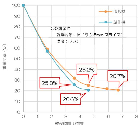
図 2 試作機の真空ポンプ変更後の乾燥速度の比較
