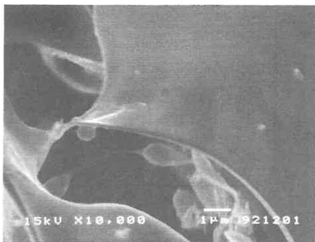
図7 凍結乾燥セリシンの電子顕微鏡写真 左：control 右：10%のエタノールを含むセリシン溶液を凍結乾燥したもの
