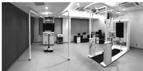
ロボットリハビリテーションセンター 写真左：バランス練習アシストロボット、 右：歩行練習アシストロボット（いずれもTOYOTA社製）
