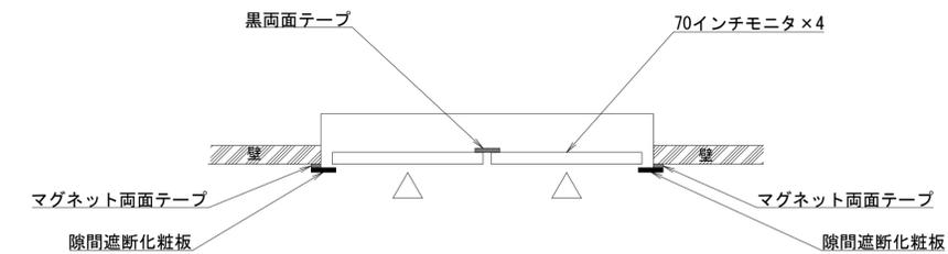
70インチ大型モニタ隙間からの光漏れ対策 (今回施工)
