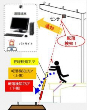
2Dセンサーを利用したホーム転落検知
