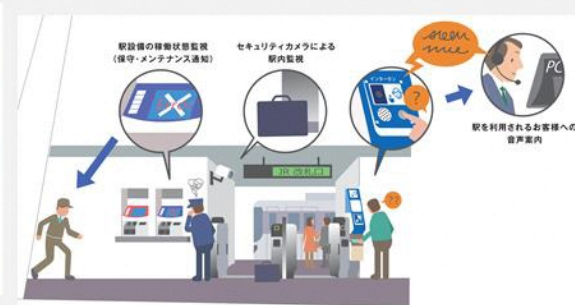
設備・カメラ遠隔監視システム
