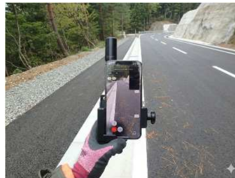
3Dデータを取得する機器（iPhone、中距離LiDAR）の導入
