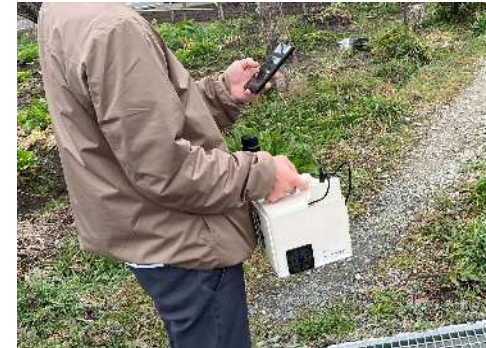
3Dデータを取得する機器（iPhone、中距離LiDAR）の導入
