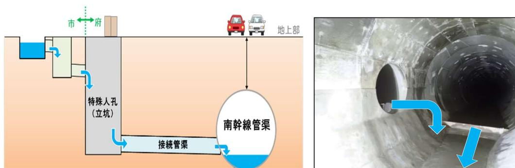
図 4.6 公共下水道接続施設（左：イメージ図、右：南幹線接続部）
