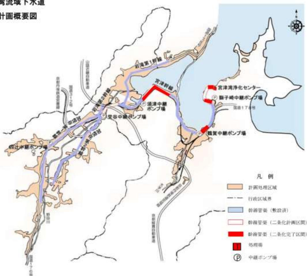
図 2.5 宮津湾流域下水道 汚水計画概要図
