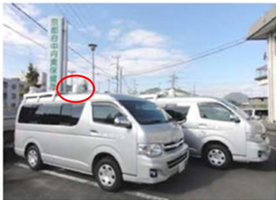
環境放射線調査車（ルート1～9） 2インチNaIを屋根上に設置
