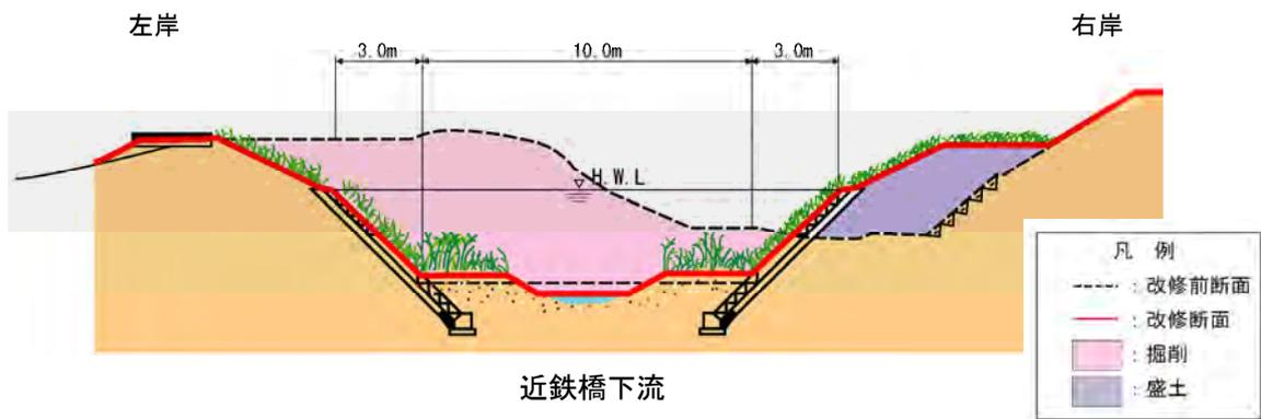
図 2-6 煤谷川の標準横断面図
