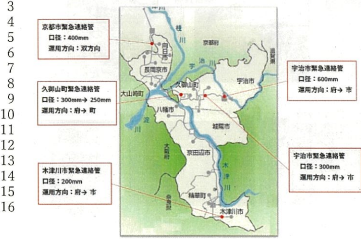
1 [資料 3-3-2 京都市・受水市町との緊急連絡管の整備状況]
