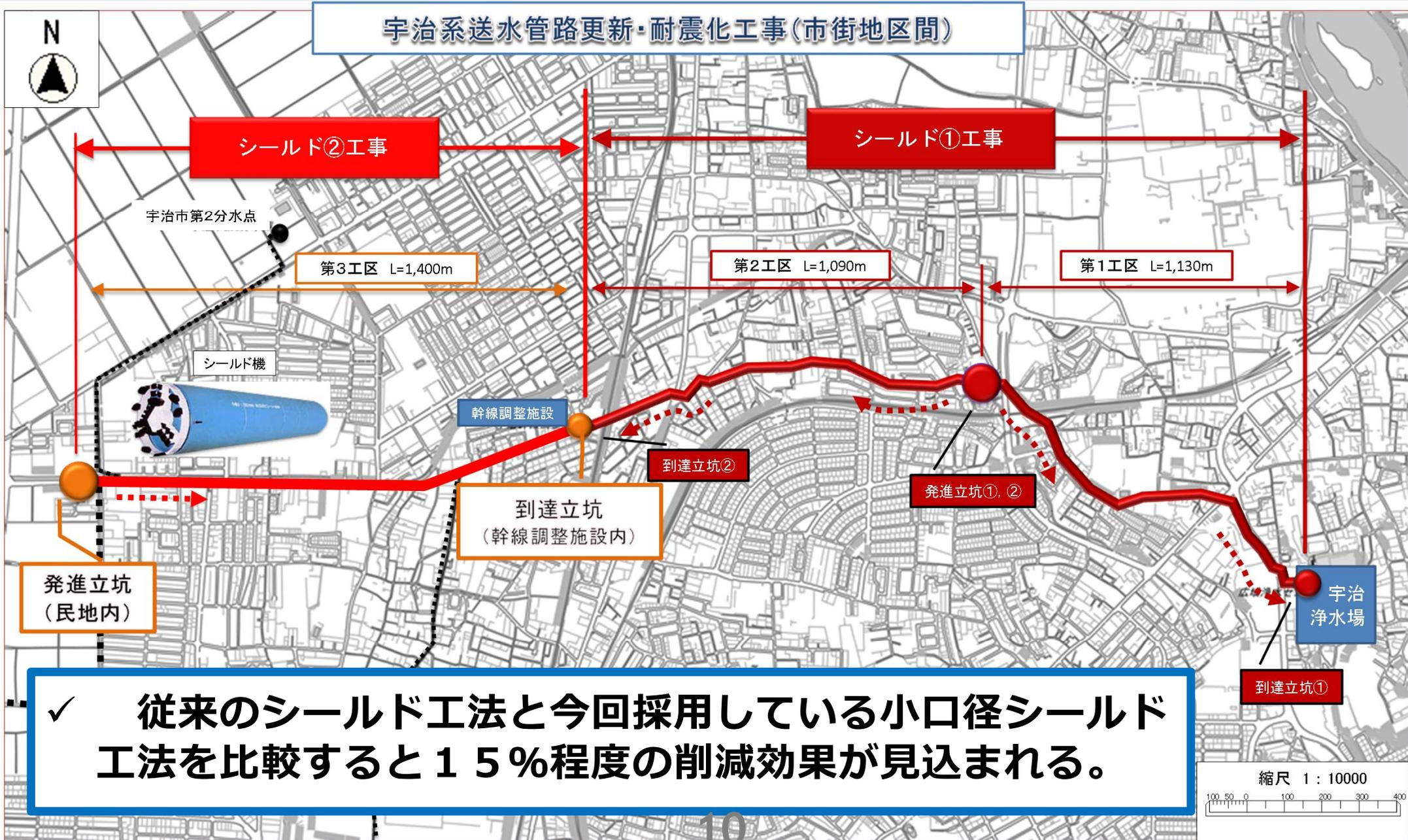
✓ 従来のシールド工法と今回採用している小口径シールド工法を比較すると15%程度の削減効果が見込まれる。
