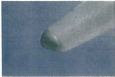
↑耐雷ブレード(先端部をアルミ化)
