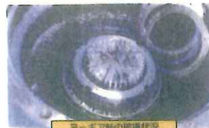
ヨーギア軸の破損状況 (下部側)
