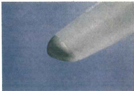
↑ 耐雷ブレード(先端部をアルミ化)
