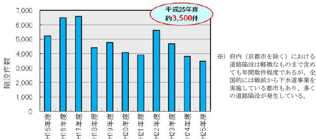
図 5-1 管路施設に起因した道路陥没件数の推移（出典：国土交通省ホームページ）
