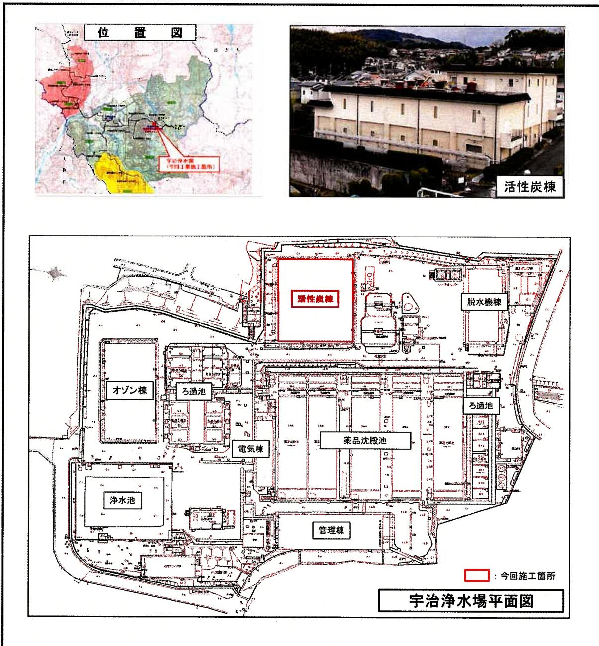
3 施工方法（高度浄水処理全体を停止することなく施工対象2池の機械設備を更新）
