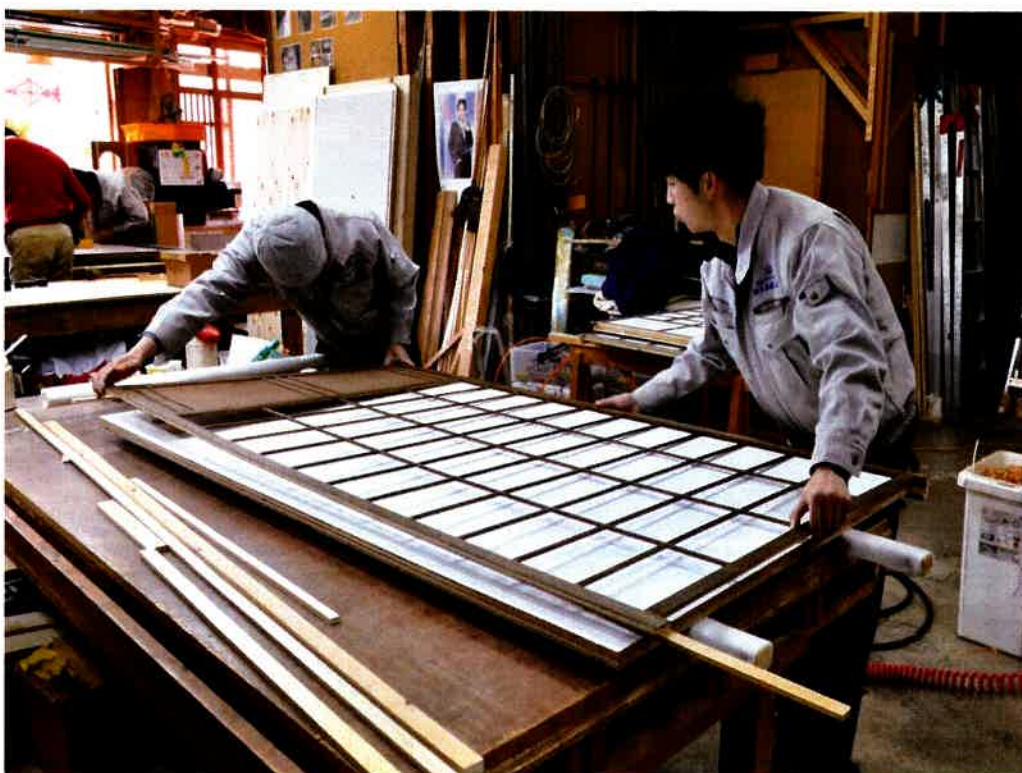
耐震補強建具製作中の状況
