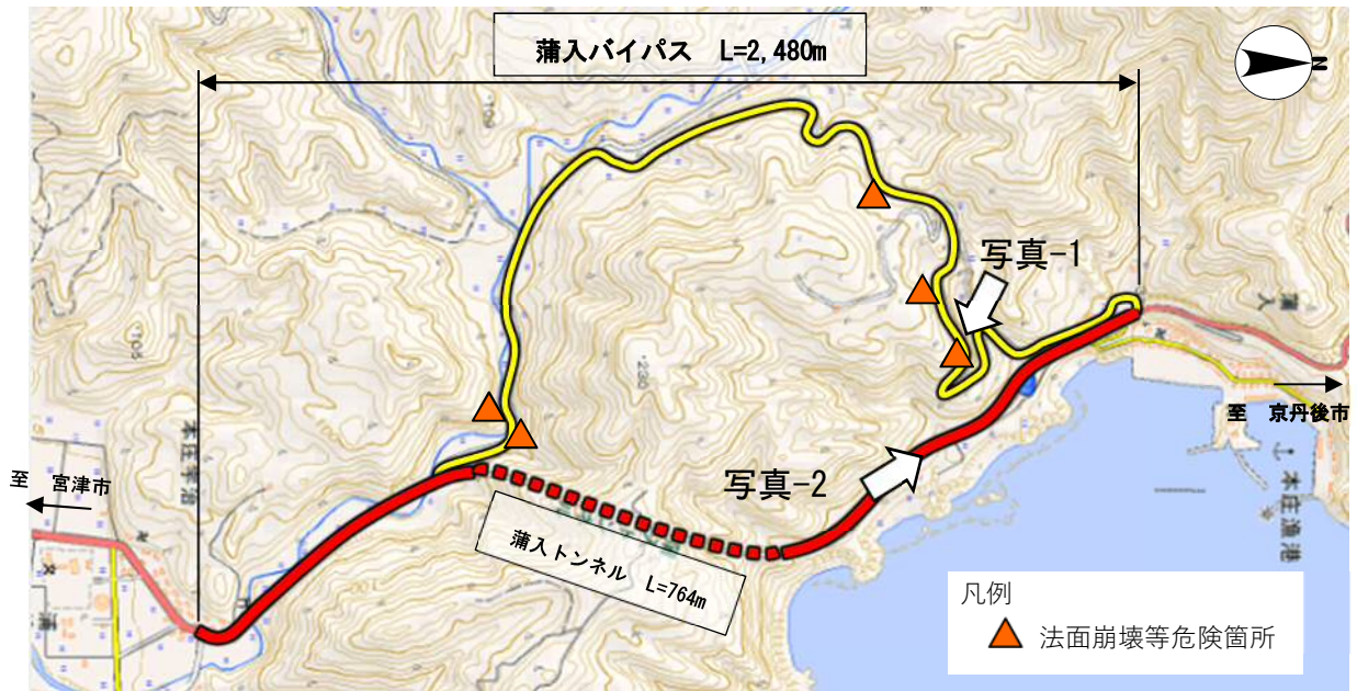
図-3 蒲入バイパスと法面崩壊等危険箇所の位置関係
