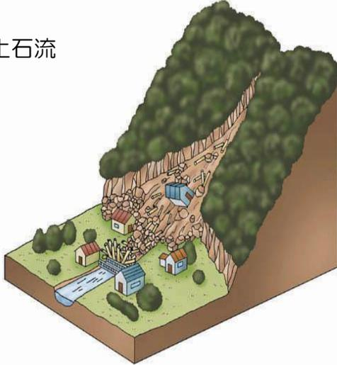
山腹や溪床を構成する土砂石礫の一部が、長雨や集中豪雨などによって水と一体となり、一気に下流へ押し流される現象
