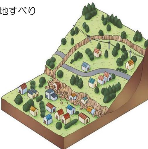
斜面の土塊が、地下水などの影響により、地すべり面に沿ってゆっくりと斜面方向へ移動する現象
