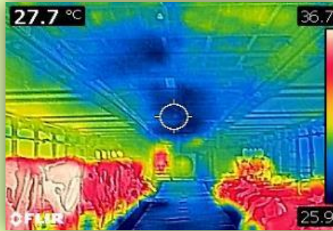
畜舎内の送風と散水を有効に活用すると5度程度温度が下がります
