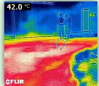
畜舎周辺の地面の高温化は散水で緩和されます
