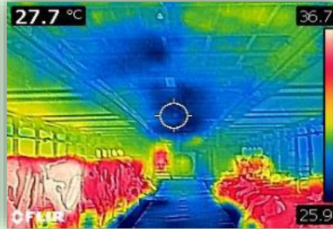
畜舎内の送風と散水を有効に活用すると5度程度温度が下がります
