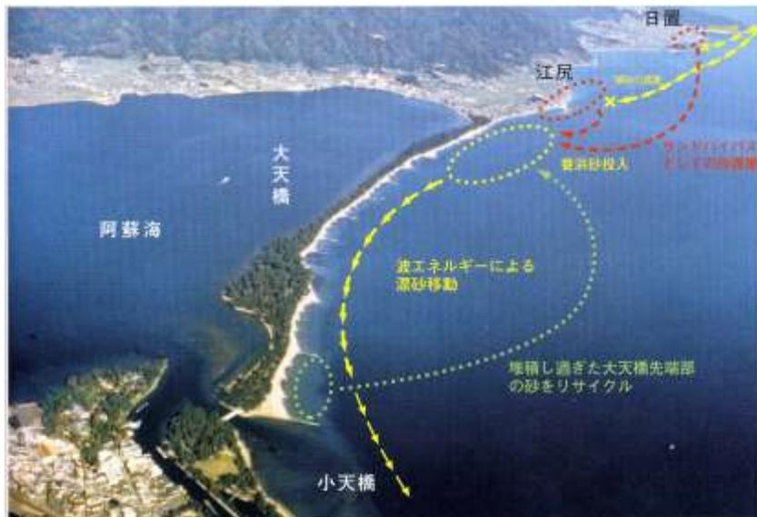
天橋立においては、昭和 61 年度からサンドバイパス工法を実施しており、漂砂上手側にある日置及び江尻の両防波堤付近に堆積する砂を船で運搬し、天橋立の大天橋付け根に投入し、後は波のエネルギーにより、天橋立全域に行き渡らせる方法を取っています。
